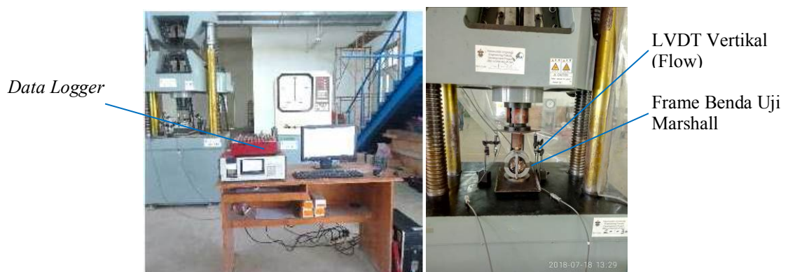
Gambar 3. Skema Pengujian Stabilitas Marshall dengan UTM
