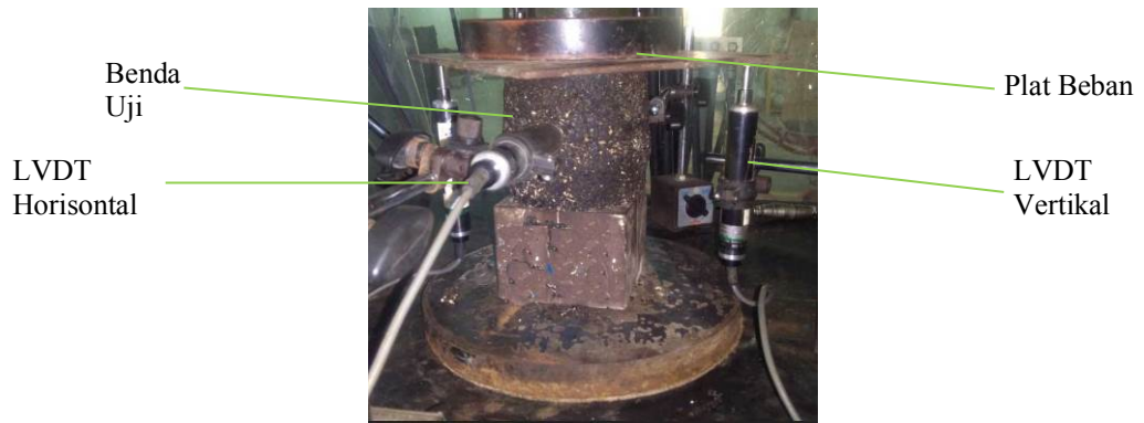
Gambar 4. Skema pengujian kuat tekan bebas
