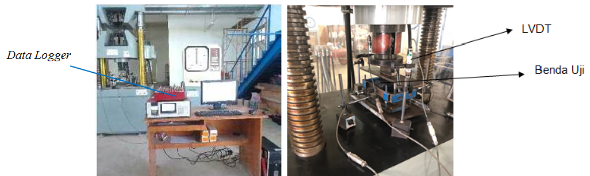
Gambar 6. Posisi benda uji pengujian kuat tarik belah ( Indirect Tensile Strength )
