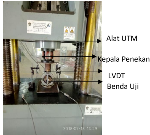
Gambar 7. Alat pengujian Marshall
