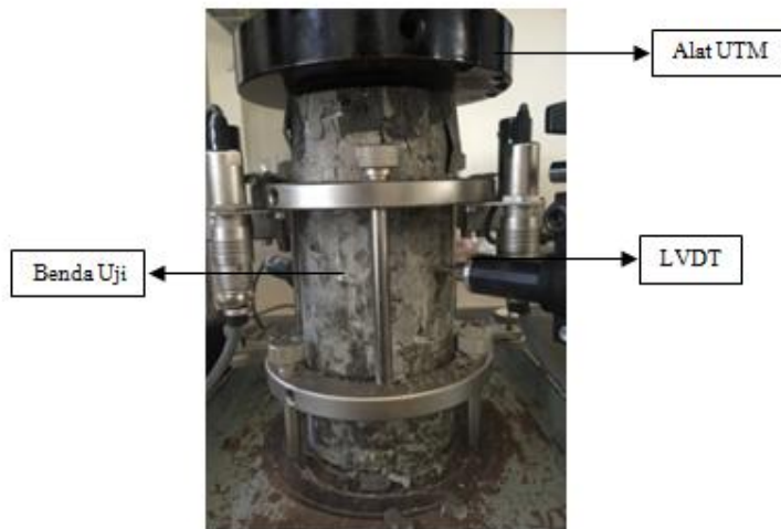
Gambar 4. Posisi benda uji pengujian kuat tekan ( Compressive strength )
