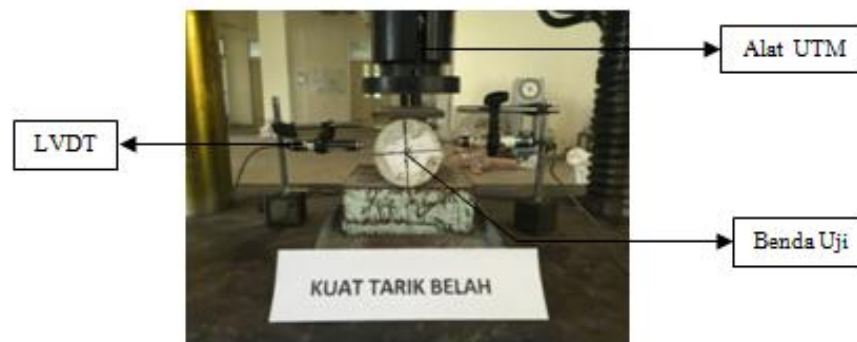
Gambar 5. Posisi benda uji pada pengujian kuat tarik belah beton
